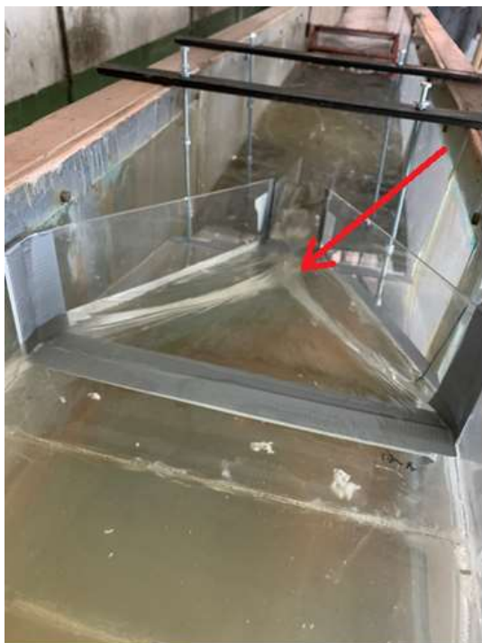
სურ. 2. ჰიდრავლიკურ ღარში განთავსებული ფართოზღურბლიანი წყალსაშვის წყალსაგდებ ნაგებობასთან შეუღლების ექსპერიმენტული კვლევის მოდელი
