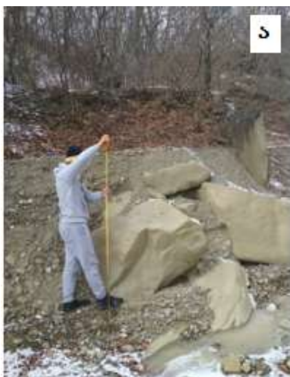
ფოტო 3. გამოტანის კონუსზე ღვარცოვის მიერ ტრანსპორტირებული ლოდები სატრანზიტო უბანზე
