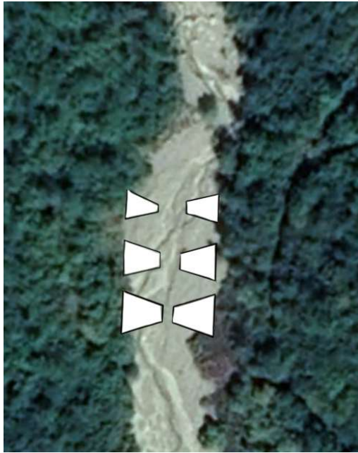
სურ. 2. მდინარე ალისხევის კალაპოტში ღვარცოფსაწინააღმდეგო ნაგებობის განთავსების სქემა
