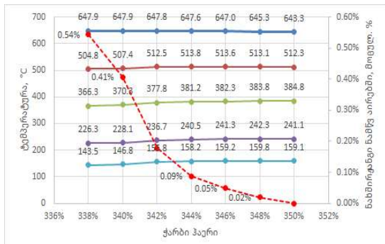
სურ. 4. აირების ტემპერატურის ცვლილება ღუმლის ტრაქტში წვის ნაწარმში ნახშირჟანგის შემცველობის ცვლილებისას:
