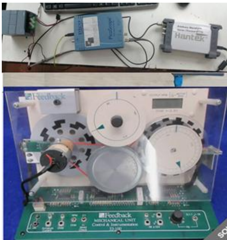
სურ. 3. სერვისისტემის ლოგიკური კონტროლერი აგებული S7-1200-ის, Picoscope-ის და Hantek-ის გამოყენებით
