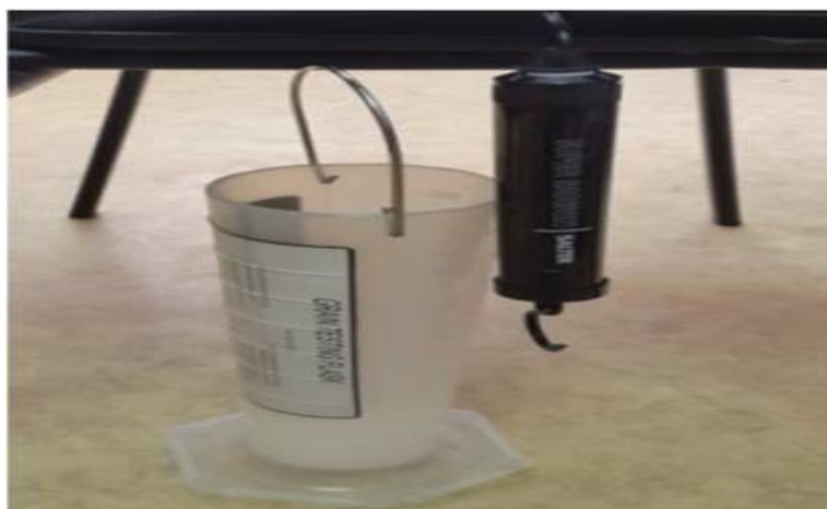
სურ. 1. Super Samson Salter კომპანიის ხორბლის ნატურის განმსაზღვრელი ხელსაწყო
